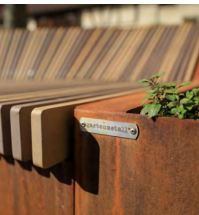
Als Bankauflage entschieden sich die Verantwortlichen für eine Auflage aus Resysta. Dabei handelt es sich um ein Naturfaser-Compound aus Reishülsen.
