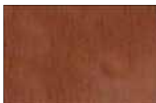
Edelrostophtik Cortenstahl vorgerostet Werkstoff-Nr.: 1.8965
