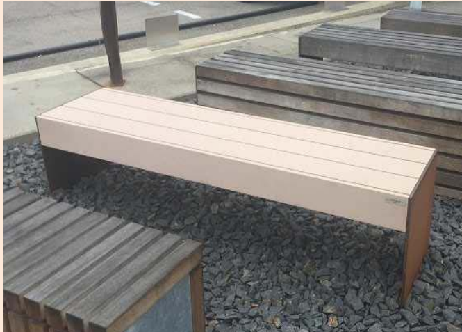
Beispiel Vergleich Vergrauung RESYSTA® und Hartholz nach ca. 24 Monaten
