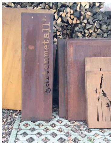
Beispiel für berosteten Cortenstahl in verschiedenen Farbnuancen.
