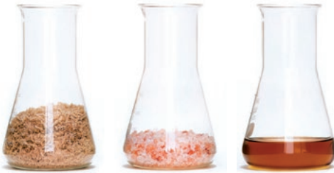
ca. 60 % Reishülsen + ca. 22 % Steinsalz + ca. 18 % Mineralöl = RESYSTA®
