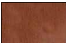
Edelrostopik Cortenstahl vorgerostet Werkstoff-Nr.: 1.8946
