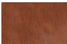
Edelrostopik Cortenstahl vorgerostet Werkstoff-Nr.: 1.8946
