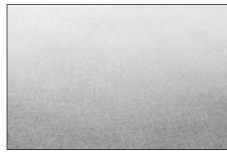
Edelstahl Oberfläche rotex-geschliffen Werkstoff-Nr.: 1.4404, V4A
