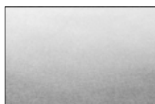
Edelstahl Oberfläche rotex-geschliffen Werkstoff-Nr.: 1.4404, V4A
