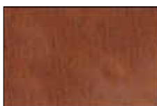
Edelrostopik Cortenstahl vorgerostet Werkstoff-Nr.: 1.8965
